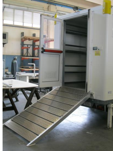
Vista externa con tarima/rampa de acceso posterior y tarima escalerilla en costado para el personal
