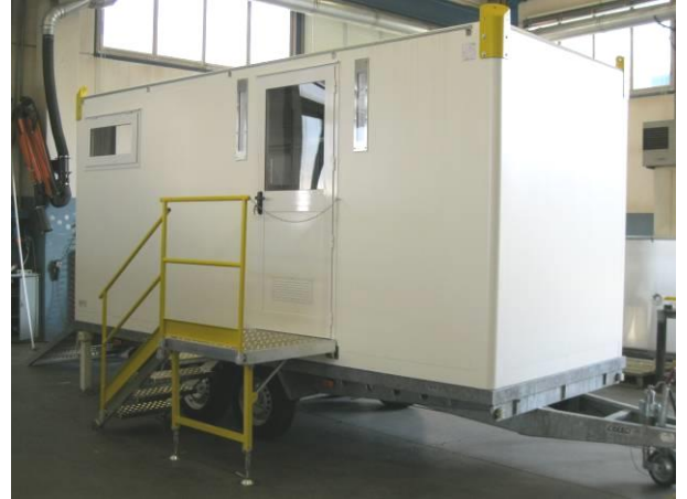
Vista externa con tarima/rampa de acceso posterior y tarima escalerilla en costado para el personal
