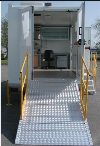
Innenansicht von der Rampe für Krankentragen an der Rückseite
