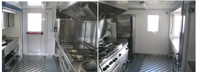
Innenansicht des Komplexes von der Eingangstür aus und Innenansicht des Systems der Raumerweiterung, mit „Herausnahme“ des Verteilungsbereichs und des Spülbeckenbereichs aus dem Trägerkörper
