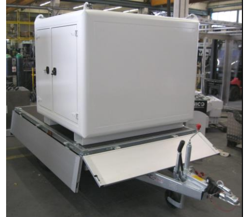
Shelter in alluminio montato sul rimorchio
