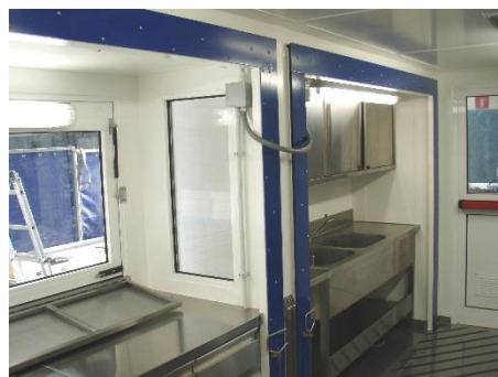
Vista parziale interna del complesso dalla porta ingresso e vista interna del sistema di espansione volumetrica, con "estrazione" dell'area distribuzione e dell'area lavello dal corpo portante
