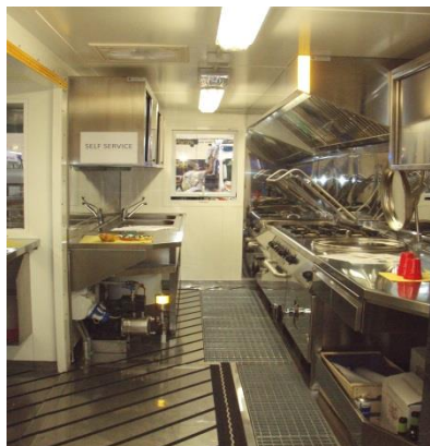
Vista interna del complesso dalla porta ingresso e vista interna del sistema di espansione volumetrica, con "estrazione" della distribuzione dal corpo portante, con pedana con scalette
